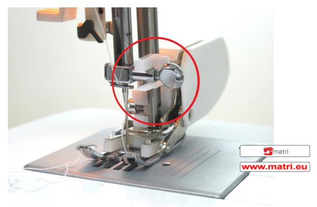
Sur le coté gauche, le pied doit être bien positionné autour l'axe de pied de biche, pour bien visser le vis.
