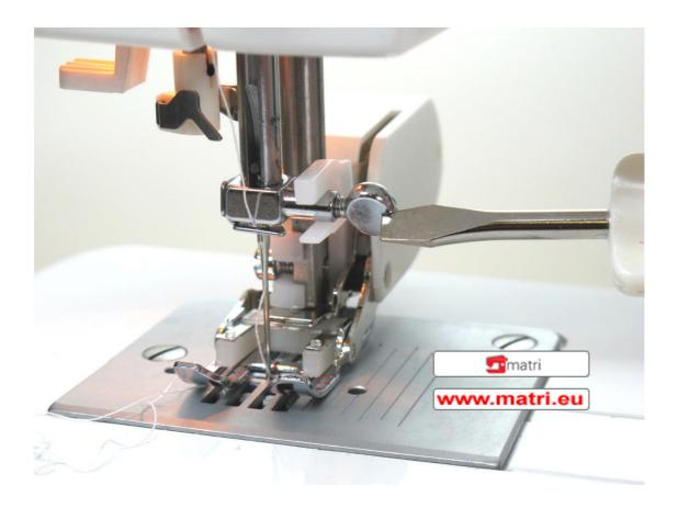
Avant de commencer de coudre, contrôlez une derniere fois si tout est bien vissé. Tournez le volant à droite de la machine. L'aiguille ne doit pas toucher le pied.
