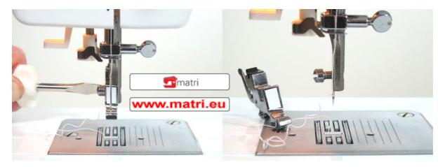
Attachez le pied transport supérieur. La partie fourché doit glisser autour du vis qui tient l'aiguille.
