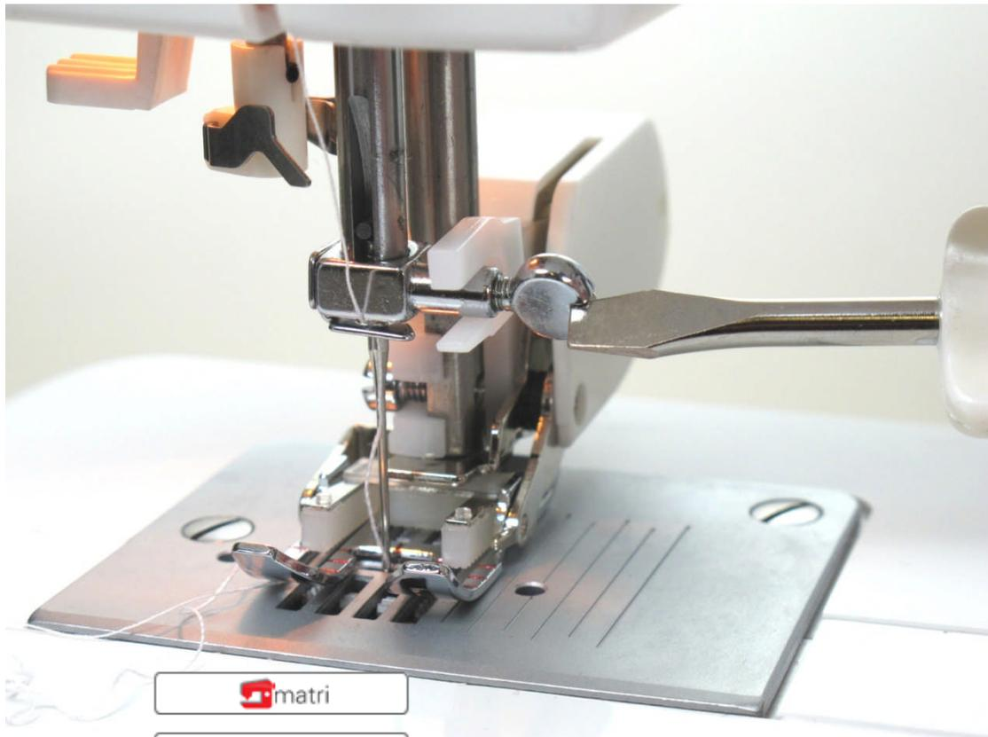
Bevor anfangen mit dem Nähen, überprüfen Sie das alles richtig fest angedreht ist. Drehen Sie das Handrad und überprüfen Sie das der Nadel den Fuß nicht berührt.
