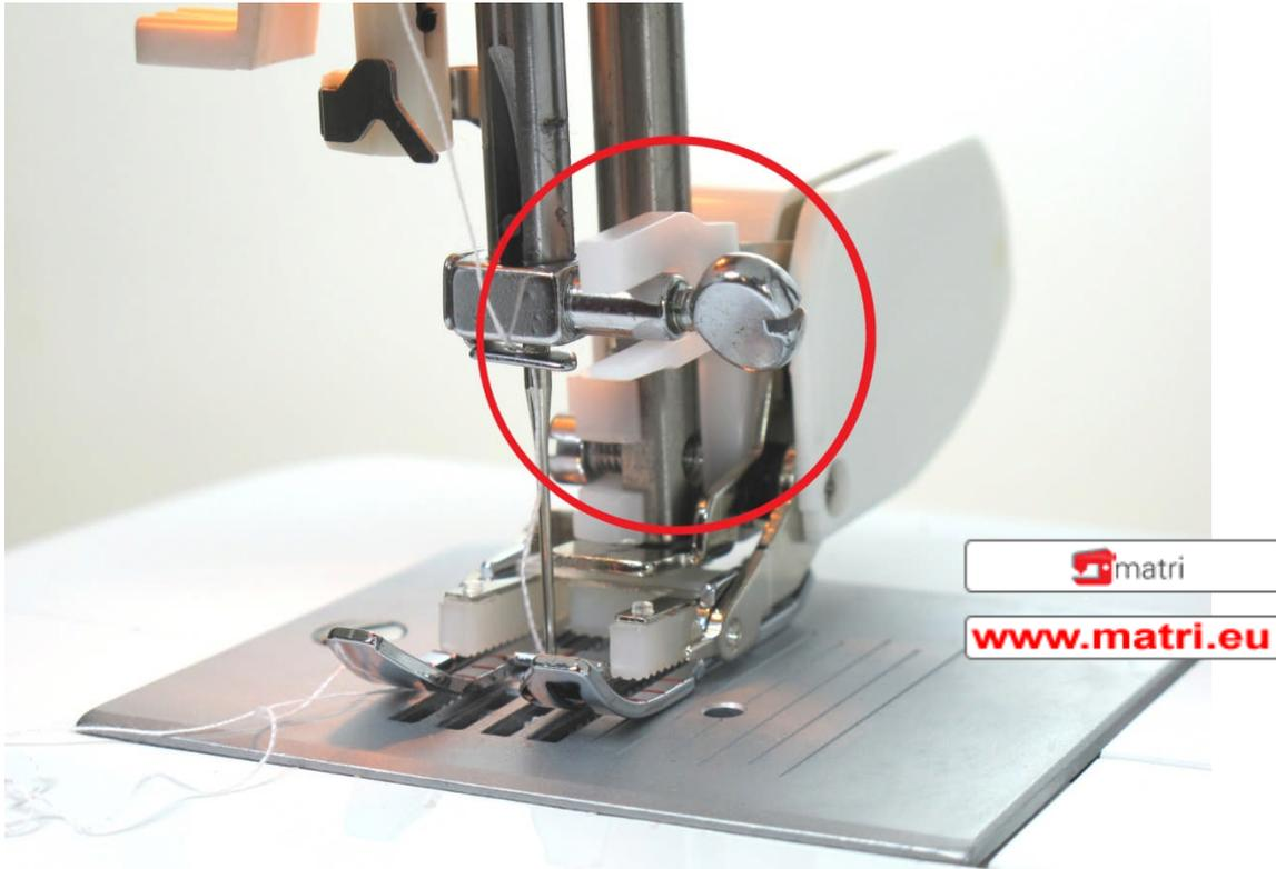
An die Linken Seite, der Fuß sollte über den Fußhalter passen damit die Schraube richtig angedreht werden kann.
